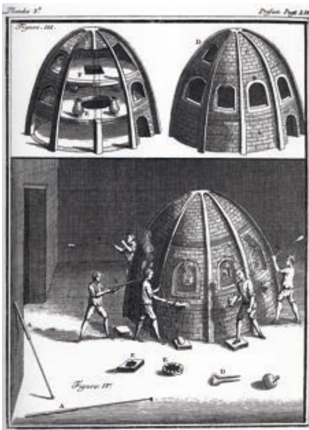
Talilna peč za steklo. Zgoraj prerez: spodaj kurišče, v sredini prostor za talilne lonce, zgoraj prostor za ohlajanje izdelkov. Spodaj prikaz pihanja steklenih izdelkov. Gre za delo L'Art de la Verrerie , ki ga je Antonio Neri izdal v Firencah leta 1612 in je izšlo v nemškem prevodu Johannesa Kunckla z naslovom Ars Vitriaria leta 1679. Hrani Pokrajinski muzej Celje.
