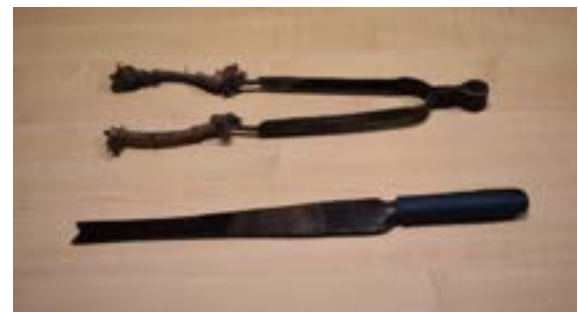
Vilice za odnašanje izdelka v hladilno peč in steklarski nož za ločevanje izdelka od steklarske pipe
